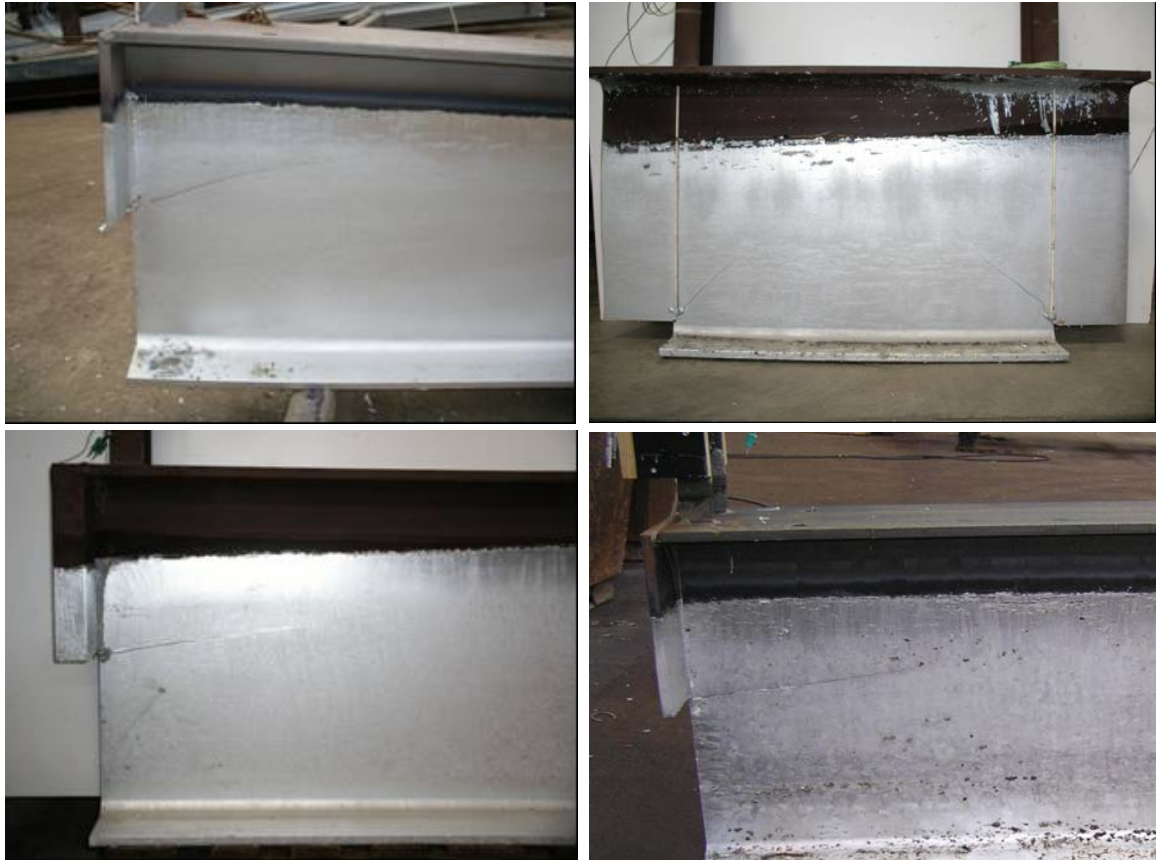
Bild 25: Rissbehaftete Versuchskörper nach den Tauchversuchen
